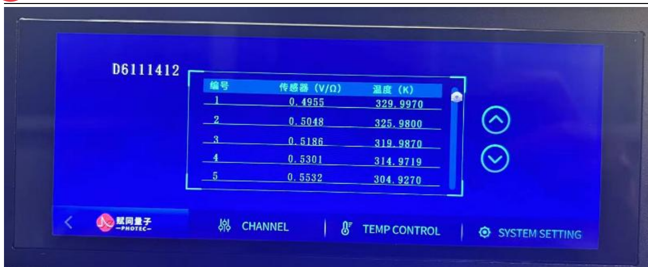
图 3-9 温度曲线数据显示界面
